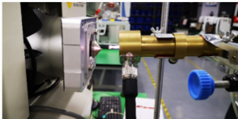
图 7 MPT-MS 实现了 ICP-MS 仅仅原子离子化功能
