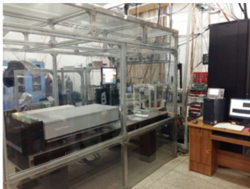
图1 团队搭建的红外光解离飞行时间质谱仪
